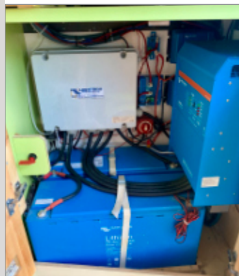
Victron Inverter, 2x Batterie 25,6V/200Ah, LiFe & Solar Controller
